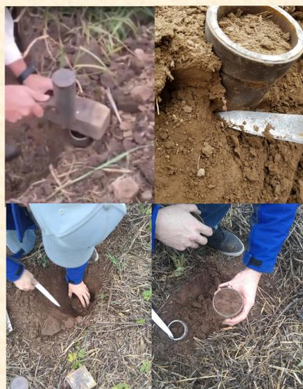
Extracción de muestra simple no perturbada con el método del cilindro para determinar D.A.
