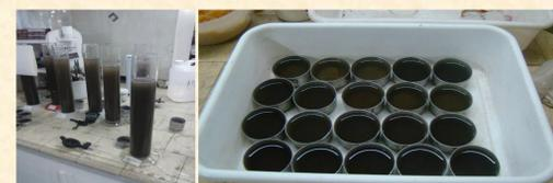
Textura aparente, sedimentación sin pretratamientos, con microagregados
