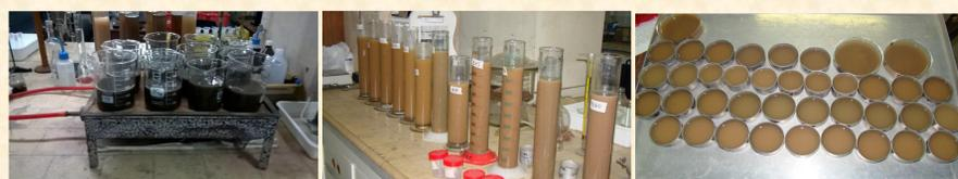
Pipeta de Robinson, eliminación de materia orgánica, probetas armadas y muestras extraídas
