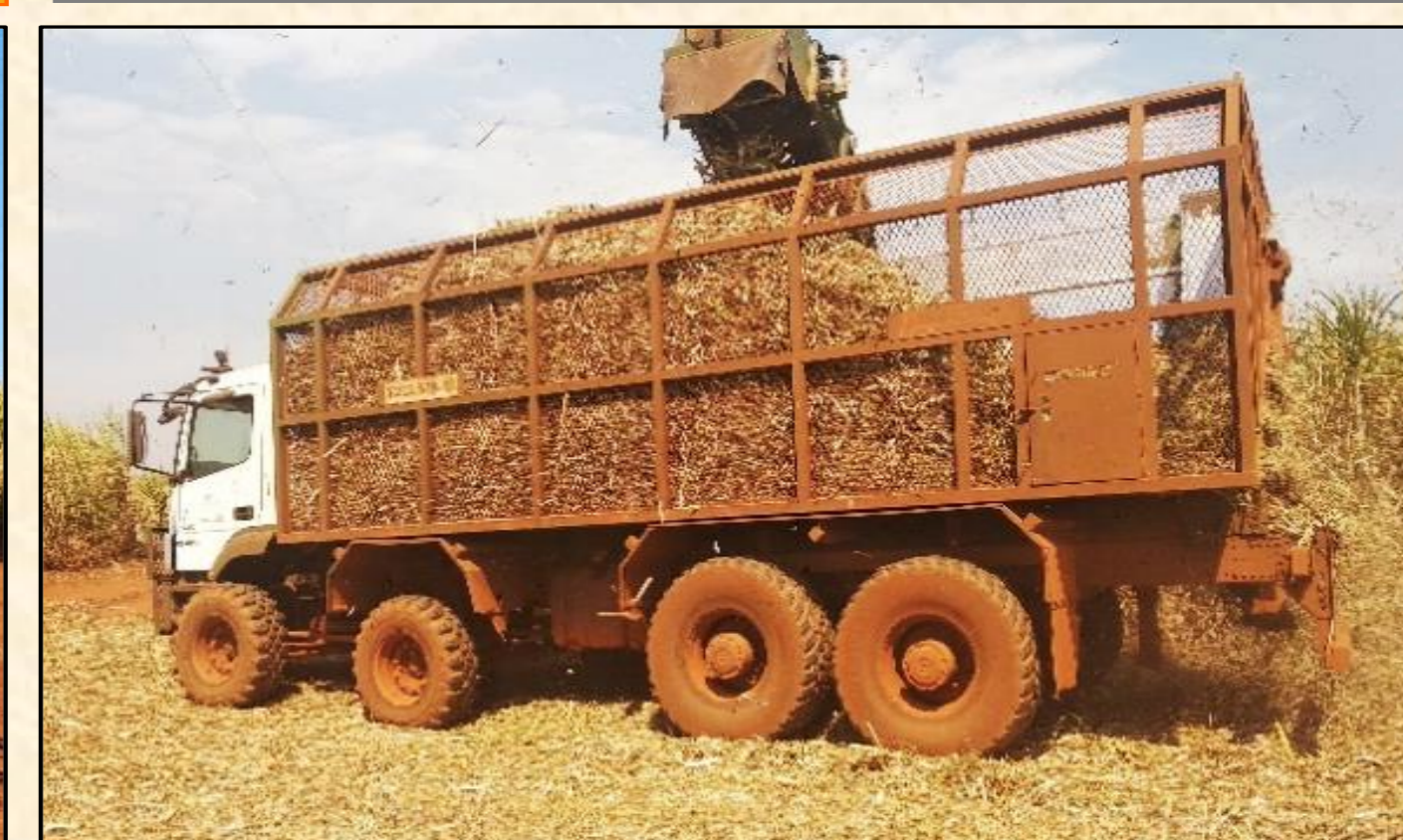
1C/20: conjunto caminhão (228 kW) + um caixote transbordo de 21 Mg
