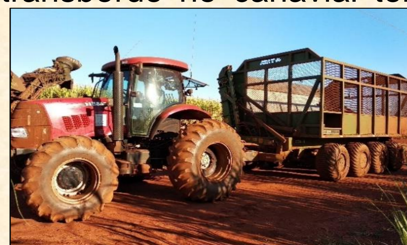
1T/21: conjunto trator (134 kW) + um caixote transbordo com capacidade de 21 Mg
