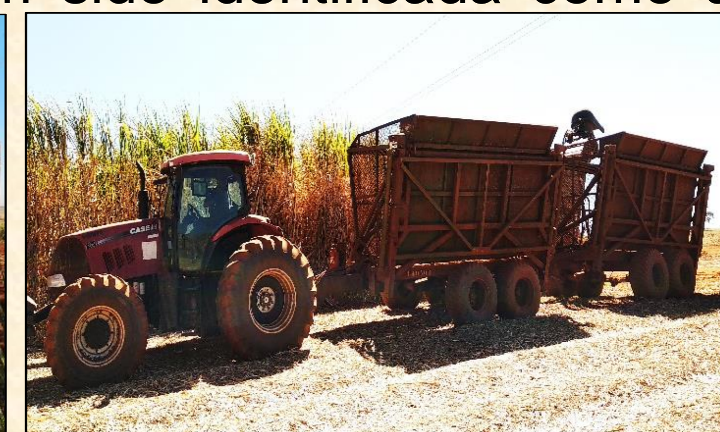
2T/10: conjunto trator (134 kW) + dois caixotes transbordos com capacidade de 10 Mg
