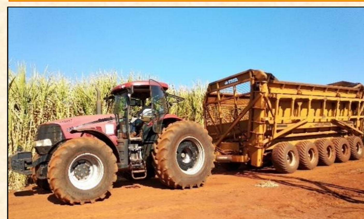
1T/30: conjunto trator (172 kW) + um caixote transbordo com capacidade de 30 Mg
