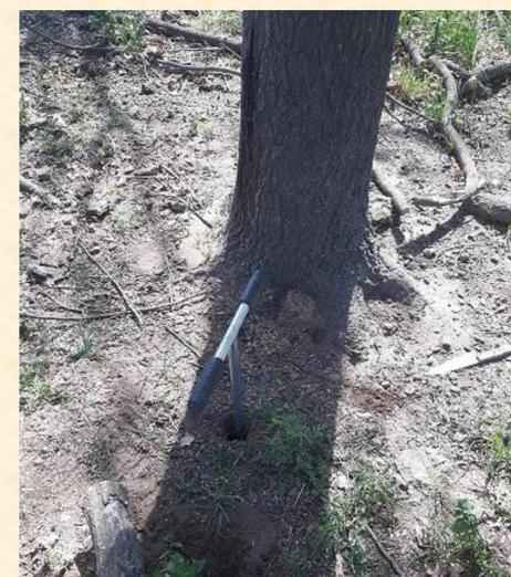
Foto 2. Muestras disturbadas tomadas con barreno a distintas profundidades.
