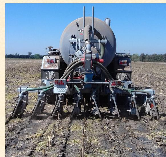
Imagen 1. Aplicación de efluentes semilíquidos de cerdo con estercolera inyectora.
