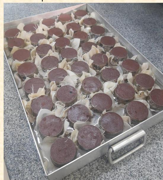
Amostra indeformada para avaliação de porosidade do solo e densidade.
