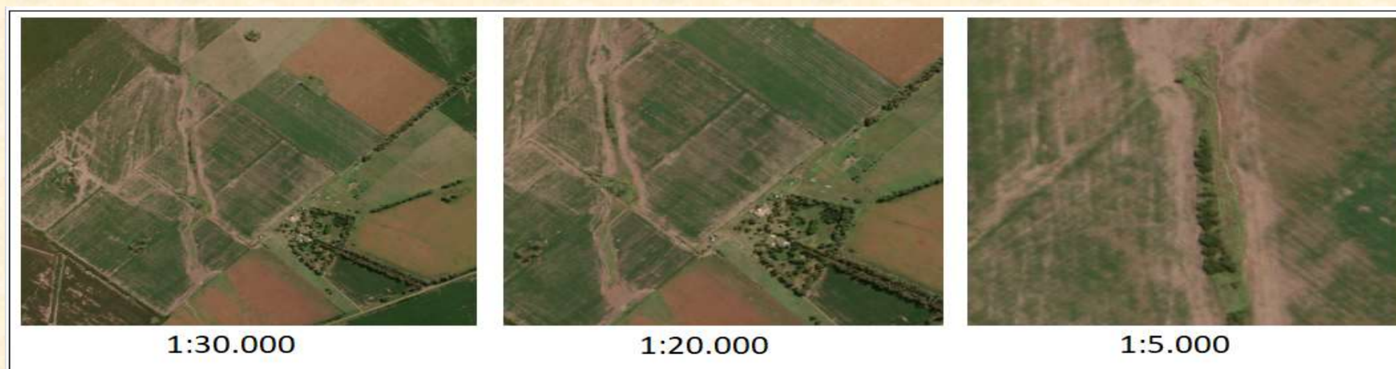
Escalas de trabajo en la digitalización de cárcavas. Identificación (1:30.000), digitalización (1:20.000), corrección (1:5.000). Fuente: Microsoft Bing Map Platform.
