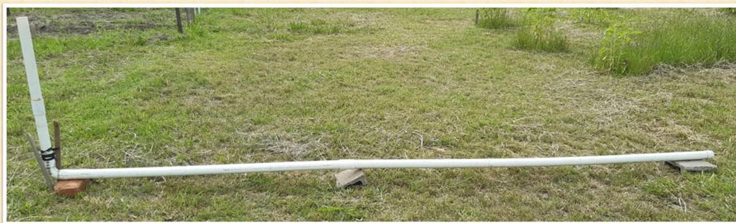
Fig 1. Permeámetro de carga constante
